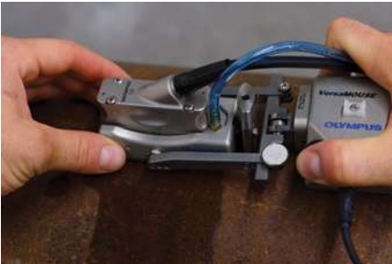
Escáneres VersaMOUSE y RexoFORM para inspeccionar corrosión.
