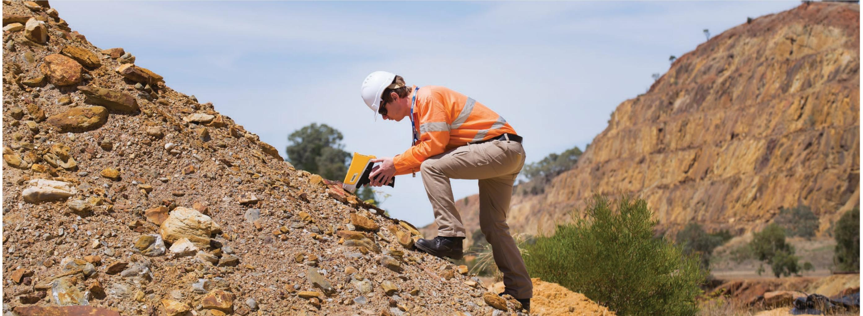
Los analizadores XRF portátiles Vanta™ de Olympus miden inmediatamente los elementos en el sitio de exploración para una gran variedad de aplicaciones geoquímicas. Los analizadores Vanta ofrecen potencia y flexibilidad a través de todo el ciclo del recurso minero:
