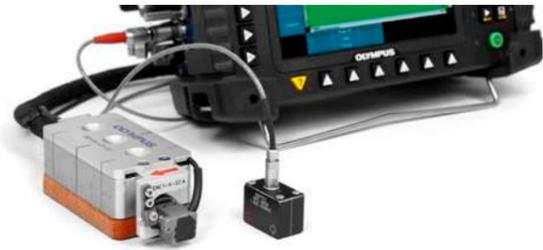
Conectar simultáneamente las sondas ECA y ECT proporciona la mejor herramienta para efectuar un trabajo sin necesidad de detener ni reconfigurar los ajustes de su hardware.
