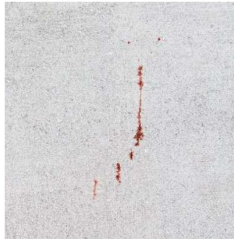
Parte inspeccionada por líquidos penetrantes (colorante rojo visible)
