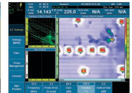
Muestra de una capa («piel») de una aeronave con defectos de corrosión. Los colores indican la profundidad del defecto.
