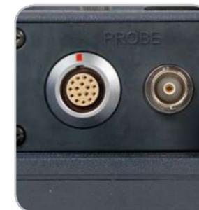
El conector LEMO de 16 pines también soporta la tecnología de sondas POWERLINK® NORTEC que reconoce automáticamente las sondas y predetermina los valores en el equipo para configuraciones más rápidas.
