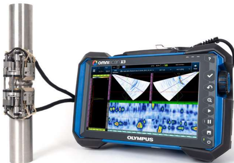
Escáner COBRA en una tubería de 0,84 pulg. con dos sondas Phased Array A15 y un detector de defectos OmniScan® MX2 de 16:64 elementos, representando dos grupos de ultrasonido multielemento mediante escaneos sectoriales y C-scan.
