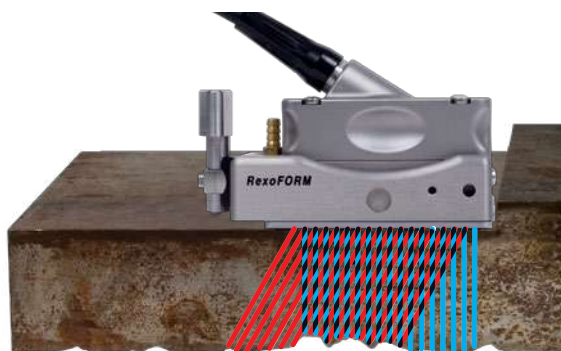
Ejemplo de un ajuste de los haces con la suela (zapata) RexoFORM y la sonda A14.
