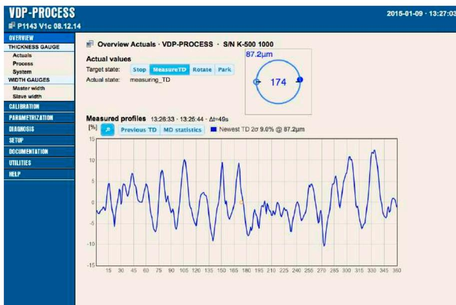
Con un explorador Web logramos el acceso al procesador de datos virtual (VDP). La parametrización y un posible diagnóstico de fallos se pueden llevar a cabo a través de una interfaz web.
