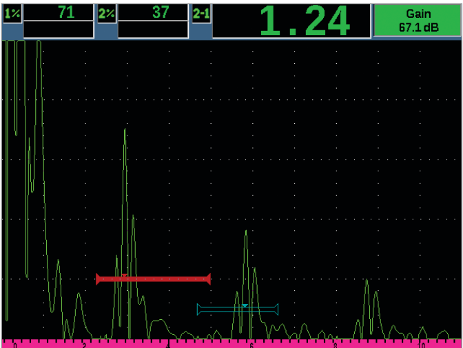
EPOCH 650: técnica eco a eco con seguimiento de puerta
