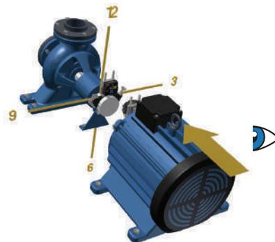
Colóquese mirando a la máquina fija (S) desde la máquina móvil (M). De ese modo la posición de las 9 queda a la izquierda, como en los programas de medición.
