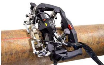
El escáner AxSEAM permite la inspección de soldaduras longitudinales en tuberías que van desde un diámetro externo de 152,4 mm (6 pulg.) de diámetro externo (D. E.) a plano.
