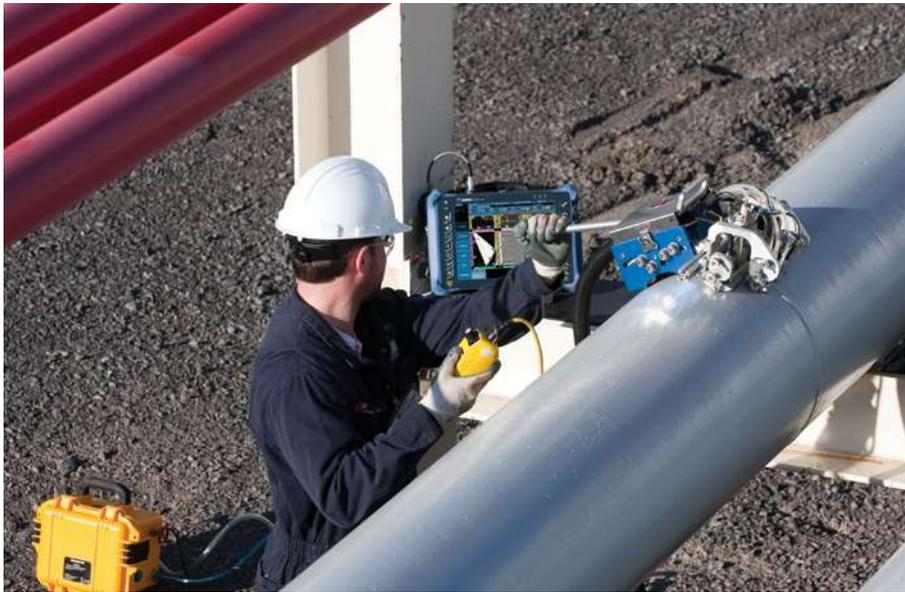
El WeldROVER™ está hecho para clientes que requieren una inspección más estable que la provista por los escáneres manuales y para quienes desean adquirir un paquete más económico de aquellos sistemas de alta discriminación de zona usados comúnmente en la construcción de tuberías marítimas.
