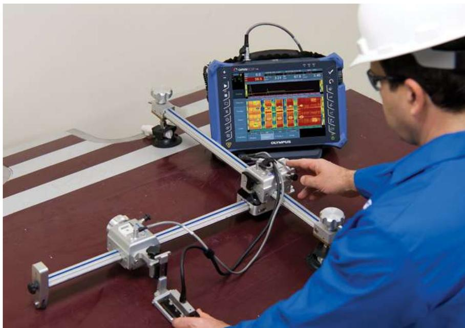
El escáner GLIDER™ de codificación a dos ejes X-Y es usado para inspeccionar manualmente superficies de compuestos ligeramente curvas o planas.
