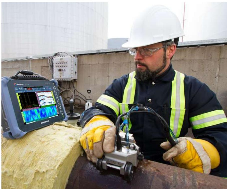
El escáner HydroFORM y la suela (zapata) RexoFORM están desarrollados para proporcionar la mejor solución de inspección cuando se requiere detectar pérdidas de espesor en materiales, producidas por corrosión, abrasión y erosión. Nuestra solución también detecta daños intermedios, como la formación de burbujas/ampollas inducida por el hidrógeno o las laminaciones inducidas por la fabricación, y diferencia fácilmente estas anomalías a partir de la pérdida de espesor de la pared.
