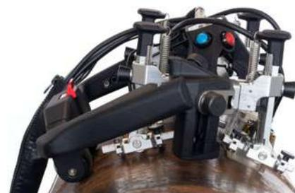
Junto con cuatro sondas, el escáner AxSEAM puede inspeccionar tuberías de forma circunferencial desde 254 mm (10 pulg.) de diámetro externo.
