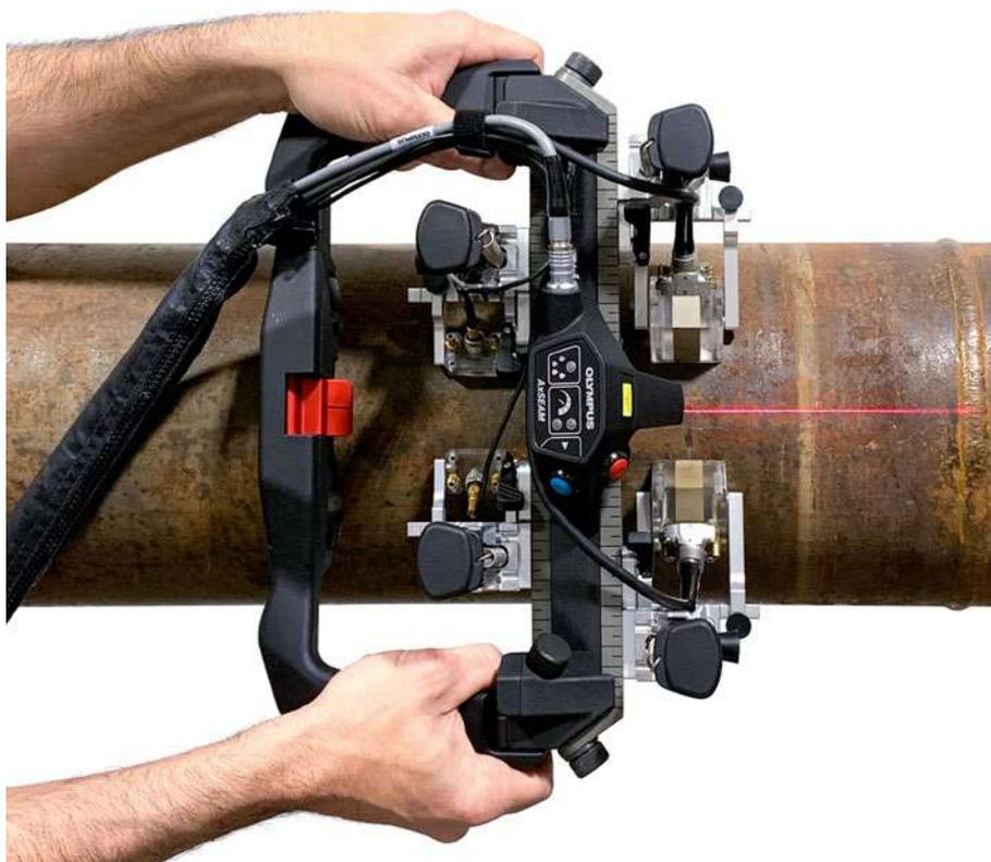
Inspeccionar cordones de soldaduras en tuberías de forma longitudinal puede plantear más desafíos que el escaneo circunferencial. Con tan sólo algunos ajustes, el usuario del escáner AxSEAM™ puede alternar fácilmente entre el escaneo longitudinal y el circunferencial, cambiar la separación de las sondas o adaptar el instrumento a los cambios diametrales a lo largo de la tubería.
