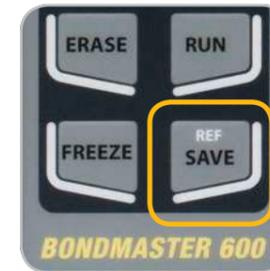
Pulse la tecla SAVE (es. Guardar) en cualquier momento, durante la inspección, para guardar las señales visualizadas.
