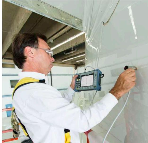
También, el BondMaster 600 muestra las lecturas en tiempo real que indican la amplitud o fase de la señal. Su nuevo modo de visualización de «Escaneo» permite, además, monitorizar la amplitud y la fase de la sonda sobre el tiempo. Esto ayuda a detectar pequeñas pérdidas de adherencia.
