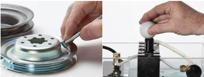
Las mediciones de espesor por ultrasonido son precisas, fiables y reproducibles/repetibles. Es posible adquirir lecturas instantáneas desde un solo lado del material sin cortar o destruir las piezas.
