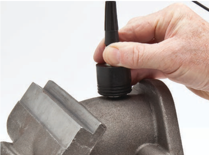
La opción de software de Alta penetración posibilita la medición de piezas de fundición metálicas.
