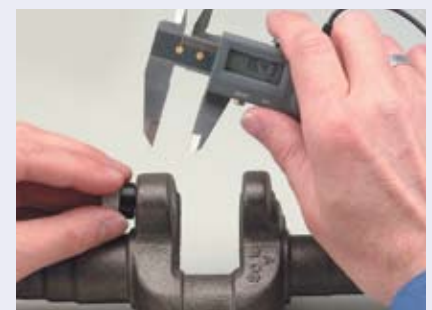
Medición del espesor mediante un calibre digital opcional.
